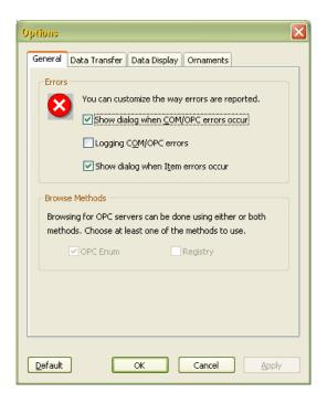
Флаг **«Show dialog when COM/OPC errors occur»** позволяет настроить отображение диалога, выдаваемого в случае возникновения в процессе работы COM- или OPC-ошибок.
