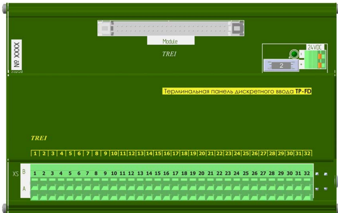
Рисунок 6 - Разъемы и лицевая панель терминальной панели TP-FD
