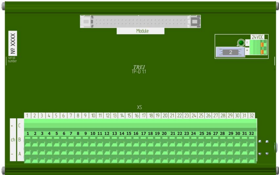
Рисунок 3 - Разъемы и лицевая панель терминальной панели TP-D
