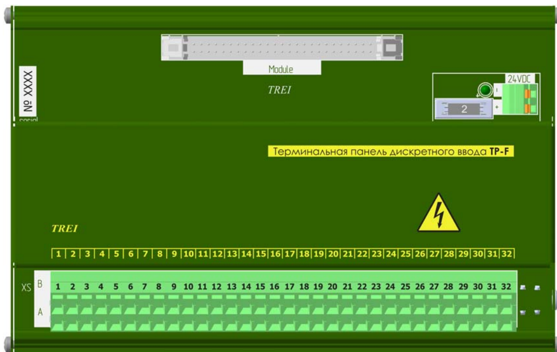
Рисунок 5 - Разъемы и лицевая панель терминальной панели TP-F
