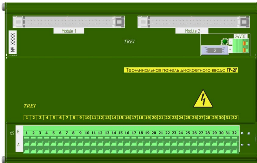
Рисунок 7 - Разъемы и лицевая панель терминальной панели TP-2F
