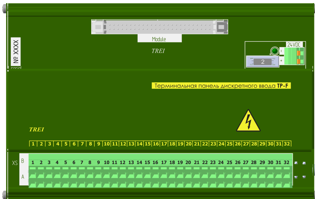
Рисунок 5 - Разъемы и лицевая панель терминальной панели TP-F
