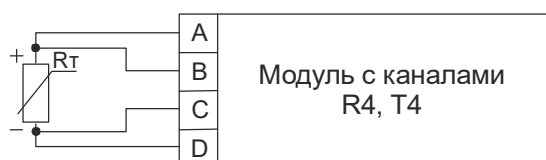
а) 4-проводная схема подключения
