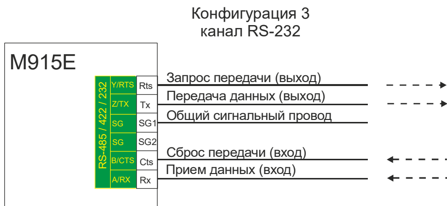
Рисунок 6 - Подключение внешних цепей к интерфейсу RS-232
