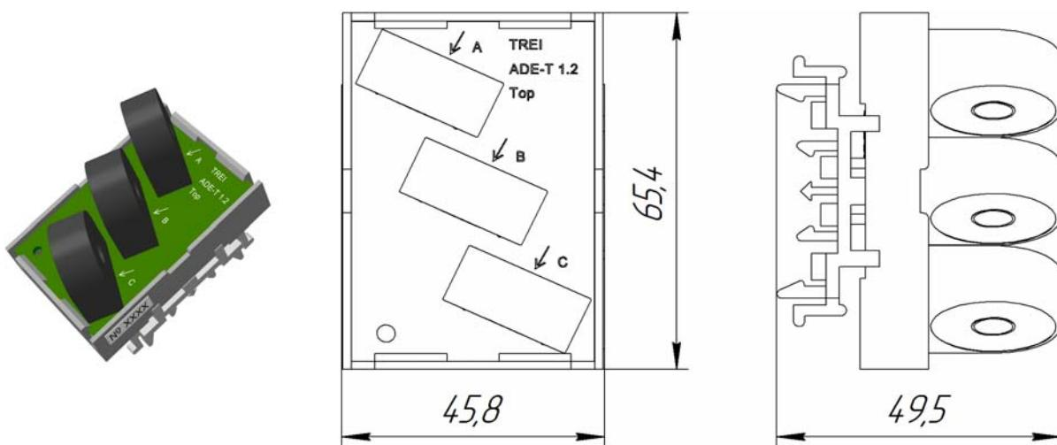
Рисунок 4 - Общий вид и габаритные размеры блока М171Н-Т
