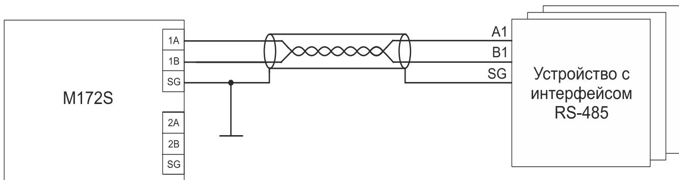
Рисунок 3 - Схема подключения с использованием кабеля “витая пара”
