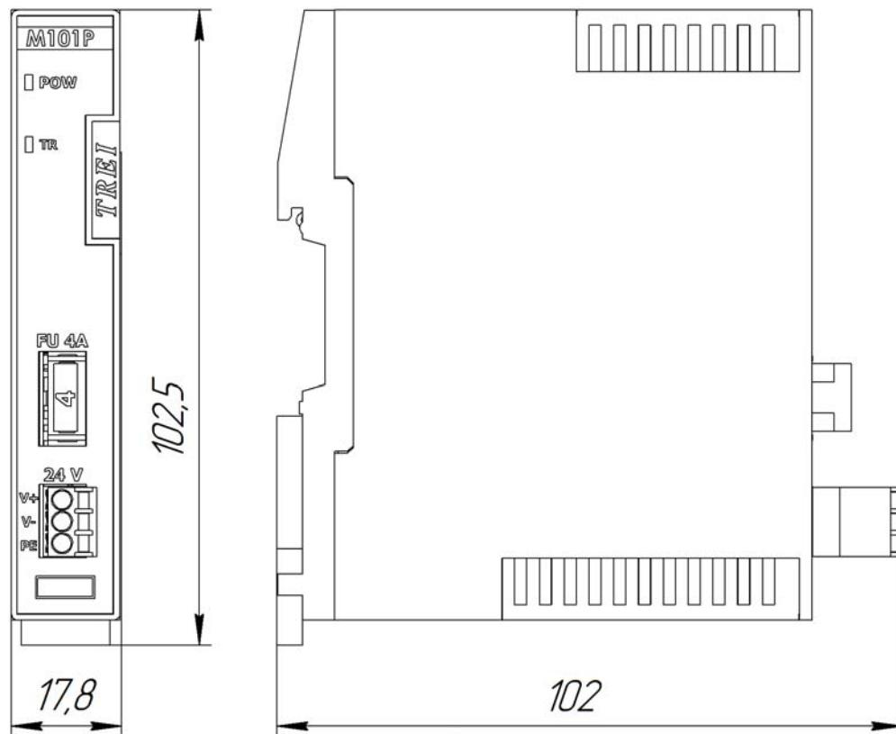
Рисунок 2 - Чертеж общего вида М101Р с указанием габаритных и присоединительных размеров
