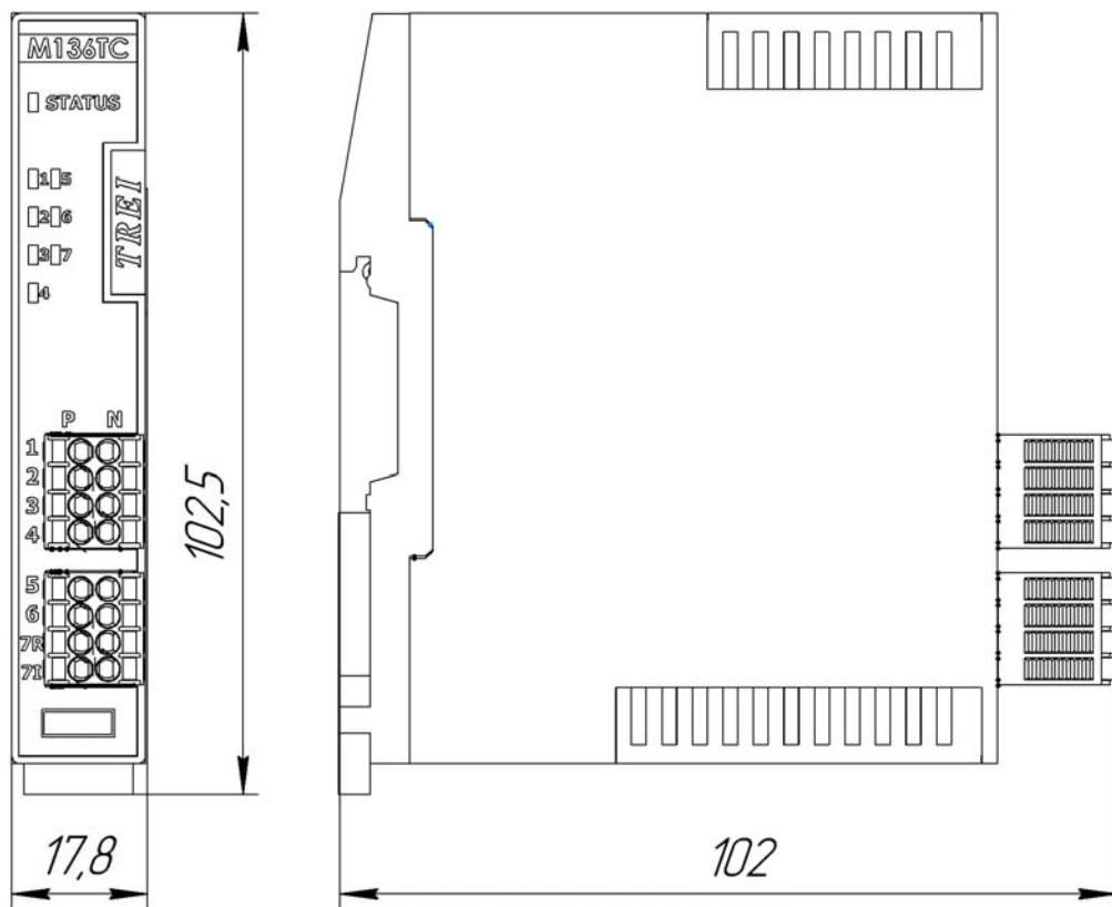
Рисунок 3 - Чертеж общего вида М136ТС с указанием габаритных и присоединительных размеров
