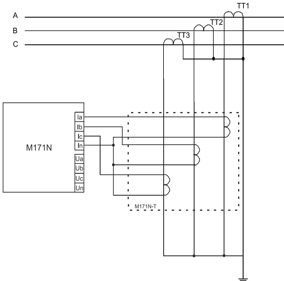
Рисунок 3 - Схема подключения модуля M171N для измерения тока\*
