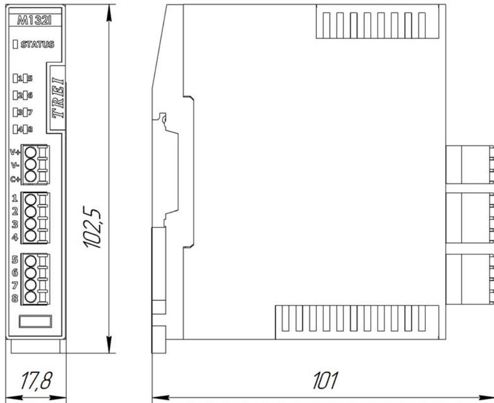
Рисунок 3 - Чертеж общего вида М132I с указанием габаритных и присоединительных размеров
