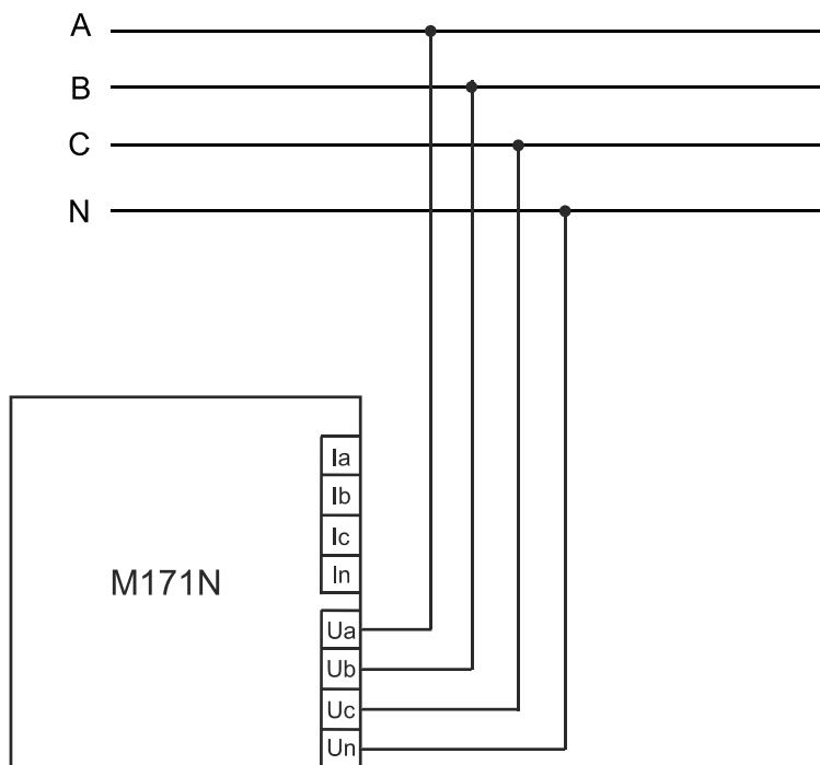
Рисунок 5 - Схема подключения модуля М171Н для измерения напряжения
