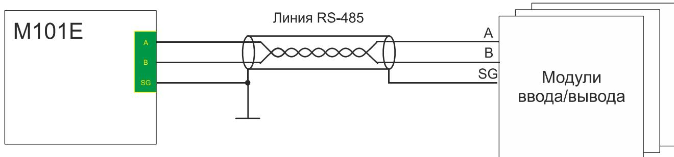
Рисунок 3 - Подключение внешних цепей к интерфейсу RS-485
