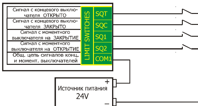
Рисунок 10 - Схема подключения дискретных входов с общим минусом и внешним источником питания
