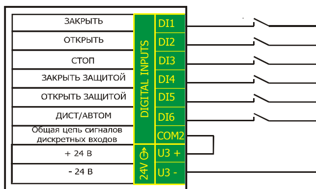
Рисунок 13 - Схема подключения дискретных входов с общим минусом и внутренним источником питания
