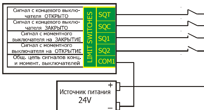
Рисунок 11 - Схема подключения дискретных входов с общим плюсом и внешним источником питания
